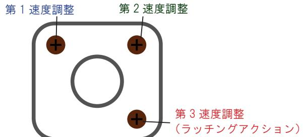
その区間の開閉速度を遅くする時は速度調整弁を右へ回し、早くしたい時は左へ回して下さい。
